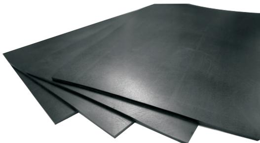
Технические пластины предназначены для изготовления резинотехнических изделий, служащих для уплотнения неподвижных соединений, предотвращения трения между металлическими поверхностями, для восприятия одиночных ударных нагрузок и п.д. Неформовая – техпластина, изготовленная методом вулканизации в котле, либо на непрерывном вулканизаторе
